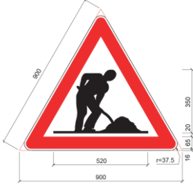
(T-15) YOLDA ÇALIŞMA
